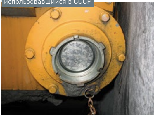
Заправочный клапан БЕЛАЗа, использовавшийся в СССР
