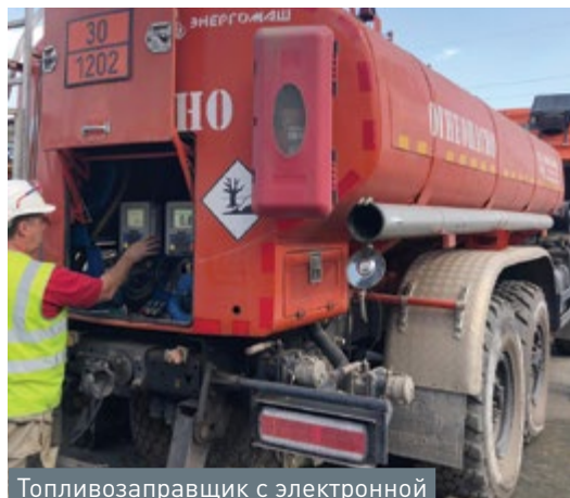
Топливозаправщик с электронной системой учета
