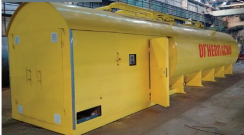
Мобильный топливный блок
