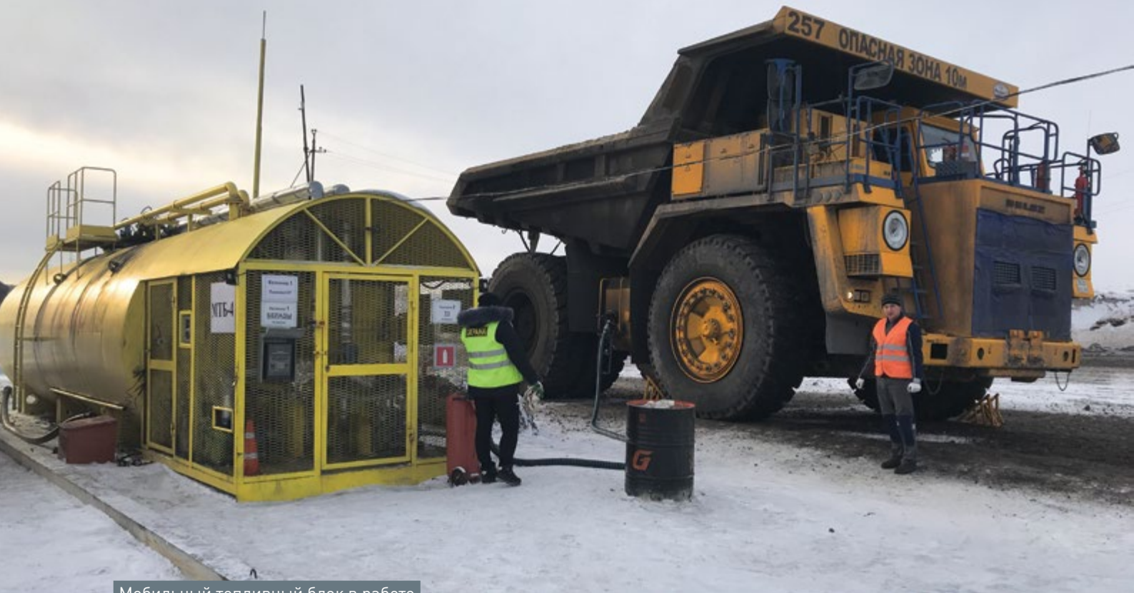
Мобильный топливный блок в работе
